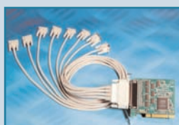
8 x 9-poliger Anschluss: UC-279
